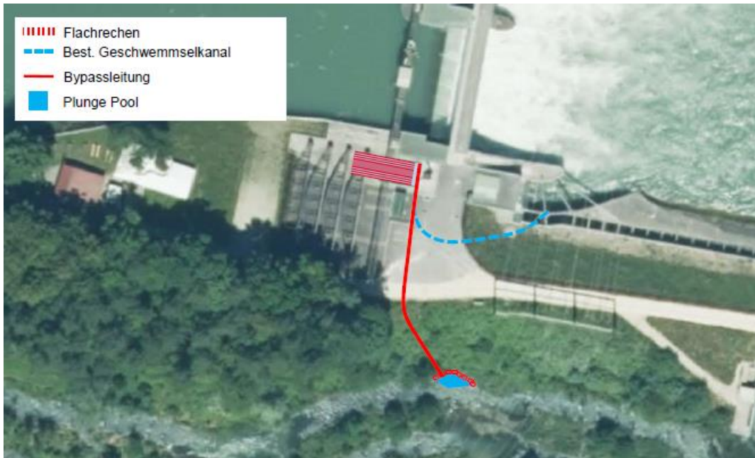
Abbildung 7: Übersicht Teilprojekt B Fischabstieg Dotierkraftwerk (Bestvariante B)
